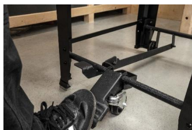
Obr. 12. Pedál v dolnej polohe – stojan stojí na kolieskach.
